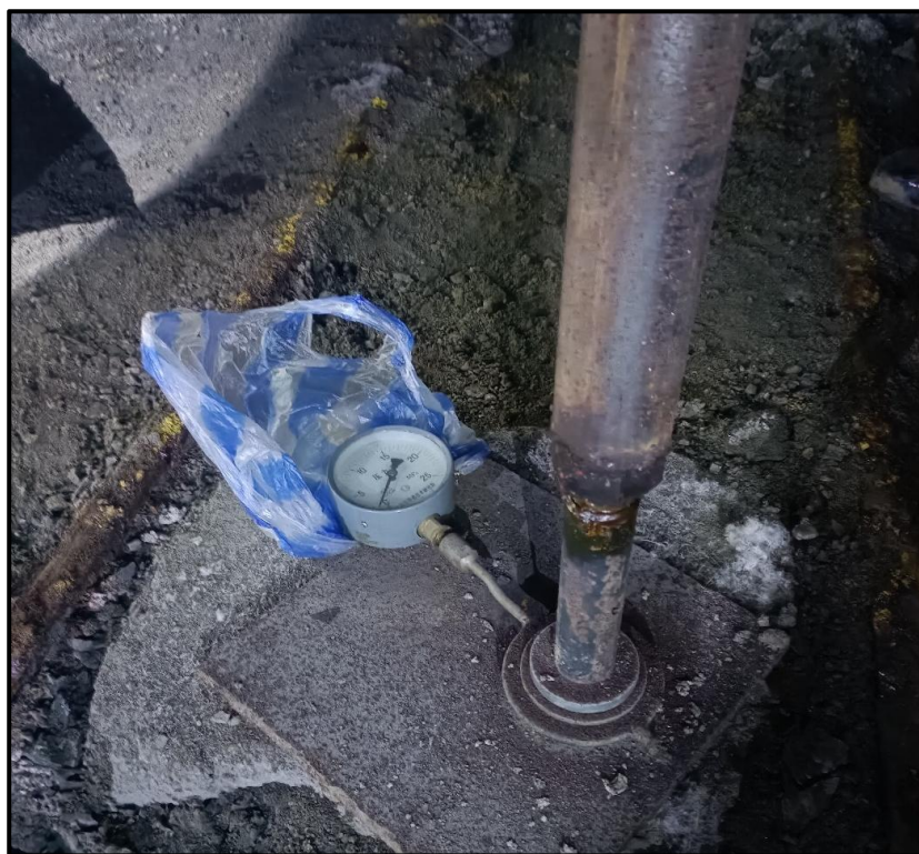
图 2-26 向阳矿区地压人工垂直应力监测设施照片
